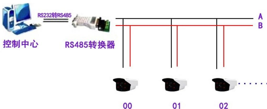
PTC052A-300 采用 RS485 方式输出的摄像头模块,它具有**实时高效、多站能力、传输距离远、组网简单**等特点。
